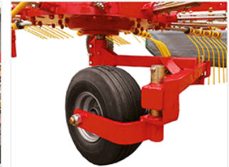
Regulacja wysokości grabienia odbywa się za pomocą ręcznej korby oraz tulei dystansowych kół kopiujących.
