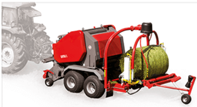
Transfer beli oraz owijanie odbywa się w trybie automatycznym
