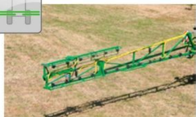
R-SYSTEM, redukcja szerokości roboczej belki, z 28/21 m, 27/21 m, 24/18 m, 21/15 m, 18/12 m.
