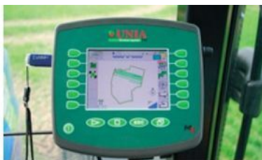
Komputer UTS z GPS z Track Leader II i Section Control umożliwia wykorzystanie zalet rolnictwa precyzyjnego.
