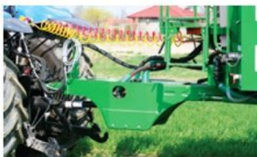
Automatyczny dyszel śledzący ułatwia prowadzenie po śladach kół ciągnika
