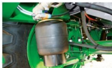
Amortyzowana pneumatyczna oś, poprawia komfort pracy i wydłuża trwałość opryskiwacza
