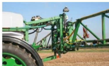
Wahadłowe zawieszenie belki zapewnia bardzo dobrą stabilizację, a system wynoszenia na czworoboku pozwala na podniesienie belki do 2,3 m
