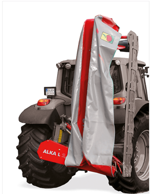
Indywidualne zabezpieczenie dysku chroni listwę przed uszkodzeniem oraz pozwala na szybkie przywrócenie kosiarki do pracy.
