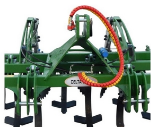
Trzy punktowy układ zawieszenia
