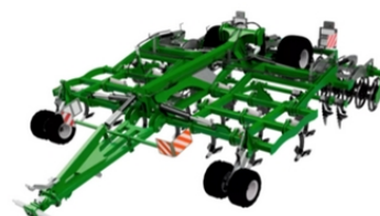
DELTA hydraulicznie składany z kołami w środku
