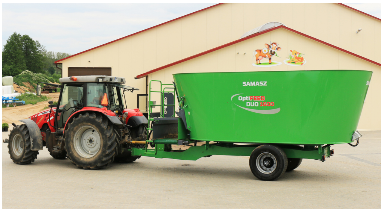
Paszowóz OptiFEED DUO 1600 firmy SaMASZ z przednią taśmą wyładowczą
