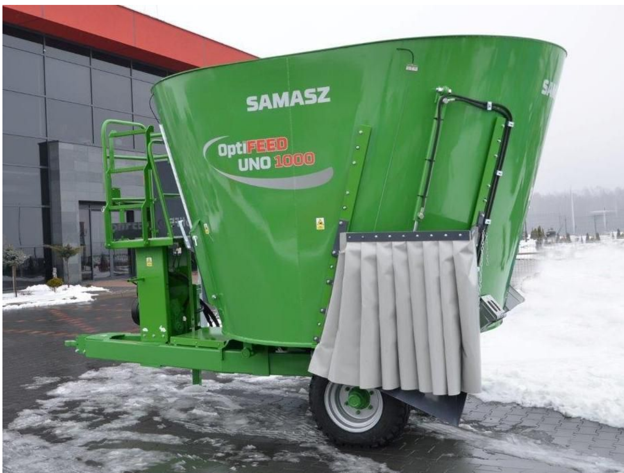
Wóz paszowy (paszowóz) SaMASZ typ OptiFEED UNO 1000
