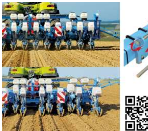
Siewnik Monosem NG Plus M ma składaną 12/8-rzędów TFC2 Mixte Microsem z przekładnią MicroDrive™.
