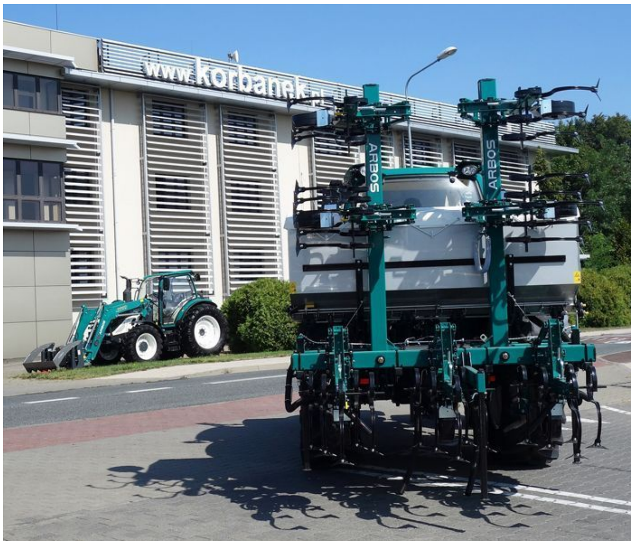
Pielnik 6 rzędowy na ramie składanej hydraulicznie
