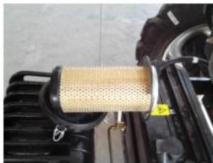
Element filtrujący suchego filtra powietrza
