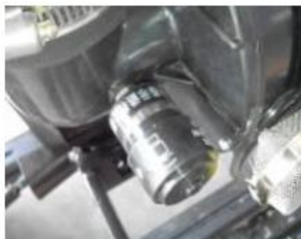
Czujnik zapchania suchego filtra powietrza
