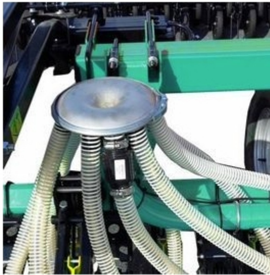
Głowica - pomiar przepustowości
