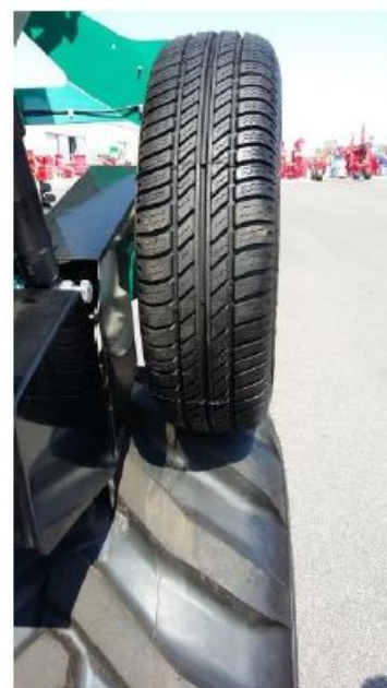
Włączony napęd z koła
