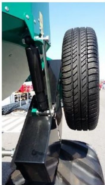
Rozłączony napęd z koła
